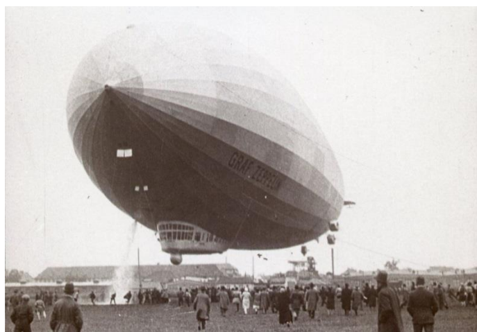
Fig. 11. Zeppelin stijgt op door middel van het lozen van ballast (water).
